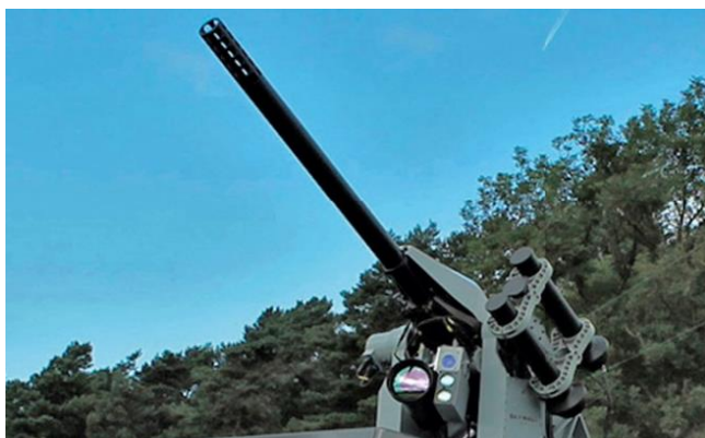
Рис.3 – Пневматическая турель для запуска снаряда с противодроновой сетью-ловушкой
