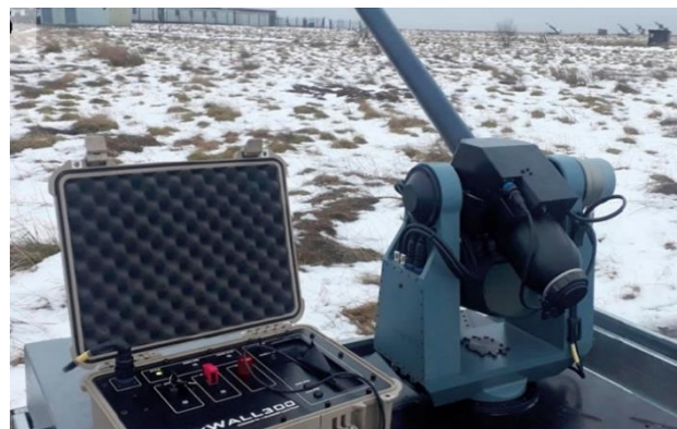
Рис.3 – Пневматическая турель для запуска снаряда с противодроновой сетью-ловушкой
